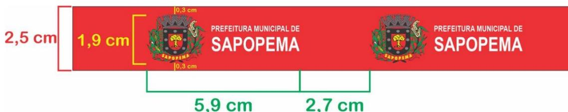
**CÓS:** Deverá ser aplicado elástico de 40mm em toda a circunferência da cintura em máquina overlock e rebatido em máquina de catraca 04 agulhas ponto corrente.
